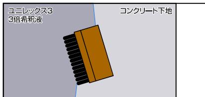
ユニレックス3 (塗布型吸水調整材) を水道水にて3倍に希釈したものをお左官刷毛等で施工面全面に塗布して吸水調整を行って下さい。
