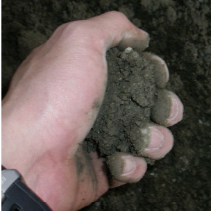
Pコンエースは超固練り(パサモル)タイプの材料です。
